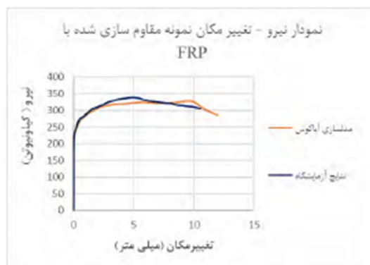
شکل (۹): مقایسه نمودار نیرو - تغییر مکان در حالت مقاوم‌سازی شده
